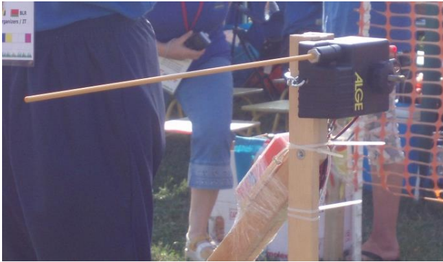
圖(十二) 衝刺專用感應主站 BS7-S 與 出發啟動器(start gate)
