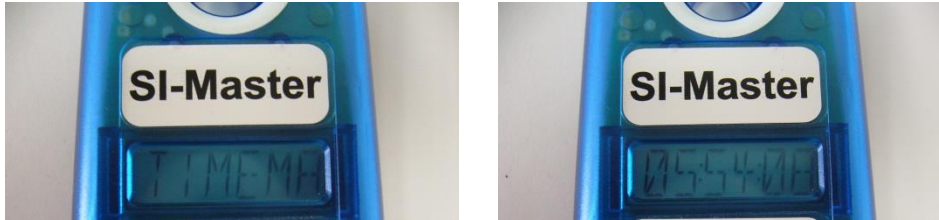
圖(七) 主感應器 時間同步功能時的螢幕顯示。 由左至右，為主感應器進入時間同步功能時，顯示螢幕依序所呈現的訊息。 (1) 目前功能 TIMEMA；(2) 內部時鐘 05:54:08。
