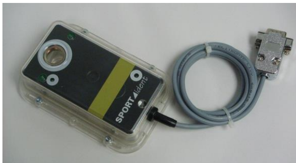
圖(十一) 列印感應主站 BS7-P ，黑色外殼，RS232 接頭。
