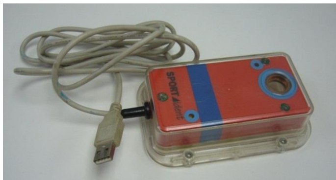
圖(十) 讀取感應主站 BSM7，紅色外殼，USB 接頭。
