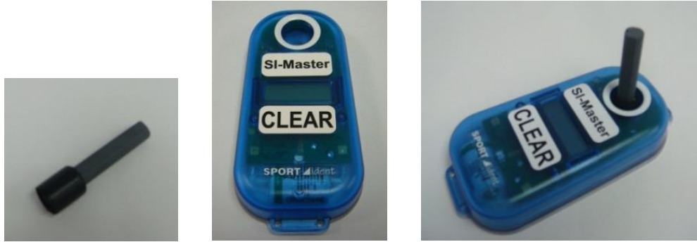
圖(九) 感應聯結棒 與 主感應器 BSF8-DT，藍色外殼。
