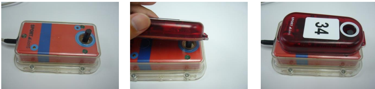
圖(十七) 由左而右為連續動作。 感應器 置於 讀取感應主站 上方， 聯結棒 貫穿兩個 感應孔 。
